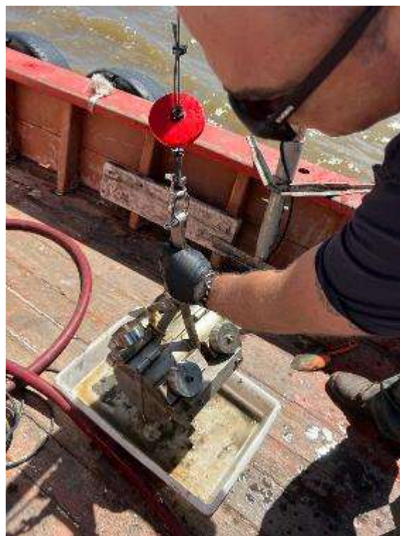
Foto 3. Utilização da draga para coleta de substrato.
