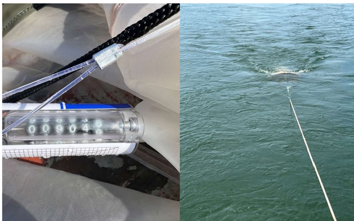
Foto 1. Fluxômetro utilizado para medição de volume, e arrasto de superfície.
